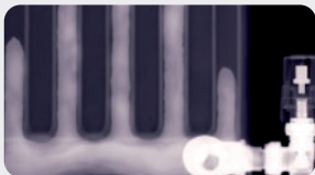
Radiateur emboué aux rayons X.
