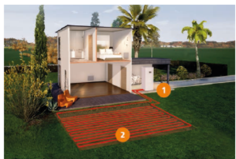
1 Pompe à Chaleur Sol/Eau. Prélèvement des calories dans le sol. 2 Capteurs horizontaux enterrés dans le sol à faible profondeur.
