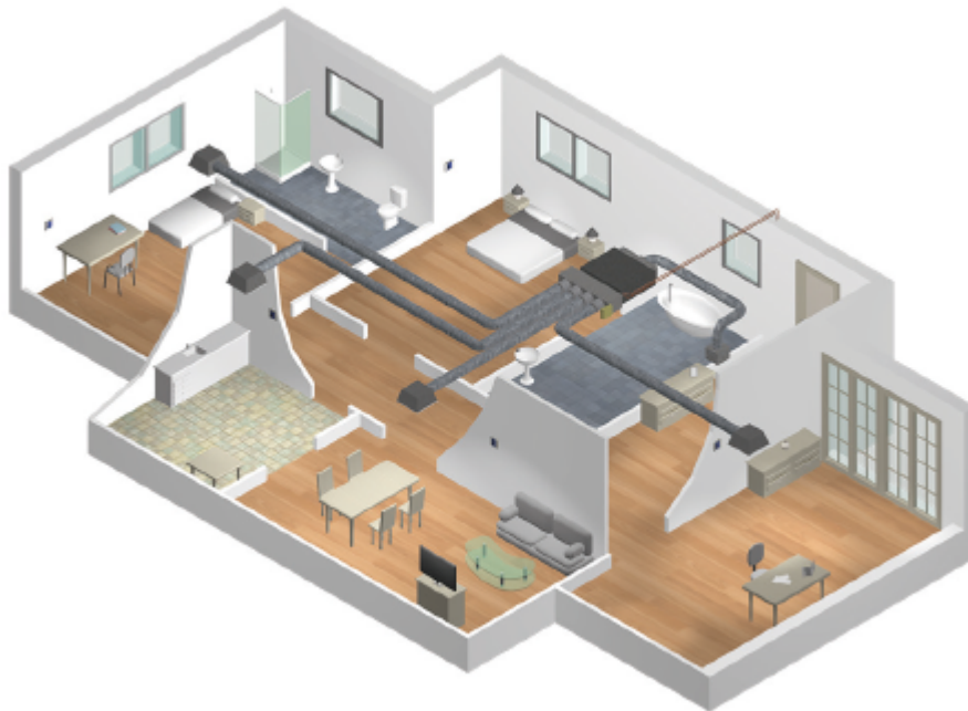
Figure 20 : Exemple d'utilisation d'une pompe à chaleur air extérieur/air intérieur en éléments séparés avec réseau aéraulique de distribution d'air multi-zones
